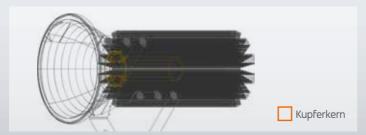
Kupferkern, Alurippen Keine Zwangskühlung mit Lüfter sondern passive Kühlung mit Kupferkern Max Temperatur 80° Celsius, bei 5-Channel Volllast (waagerecht) Max Temperatur 67,5° Celsius bei 5-Channel Volllast (senkrecht)
